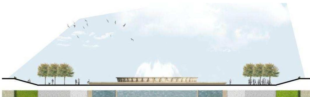
Corte esquemático da situação proposta, mostrando a extensão de área pavimentada que permite a aproximação ao tanque da Fonte, a libertação dos taludes para usos directos informais e a plantação de bosquetes de pequenas árvores retomando o desenho original de 1940.
