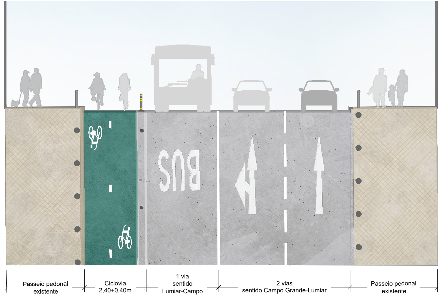
Alameda das Linhas de Torres CORTE A Escala 1:100
