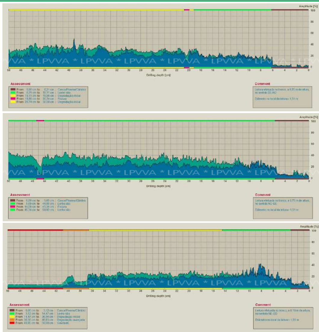
Fig. 5. Resistogramas obtidos no tronco do exemplar: as leituras foram realizadas na base do exemplar e revelam a existência de alterações do lenho. A leitura C, realizada na perna Norte revela que a cavidade se estende até, pelo menos, 0,50 m de profundidade.
