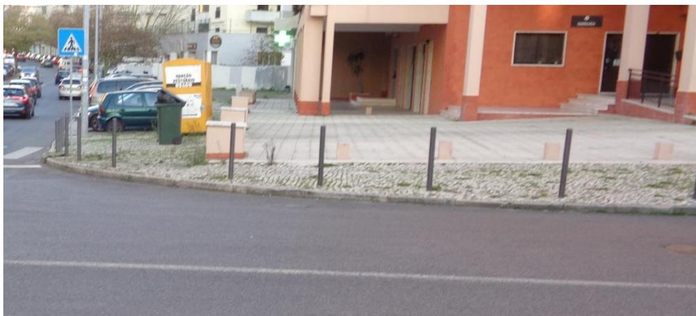
Figura 8 — Pilaretes a remover em zona de alargamento de passeio (PK 0+700)
