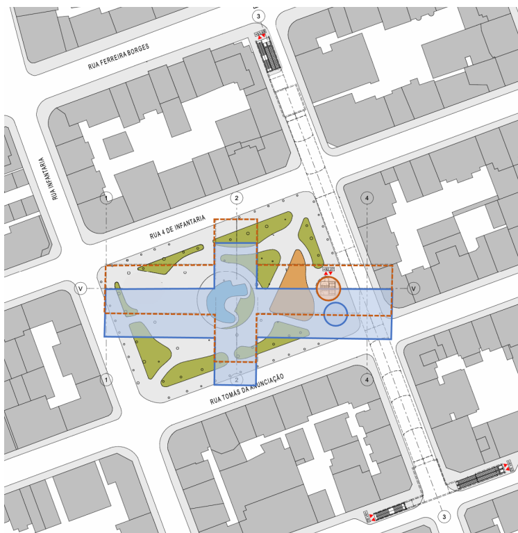
Fig. 1 – Proposta de deslocação da estação (a laranja a localização prevista e a azul a localização proposta e respectivo poço de ataque)
