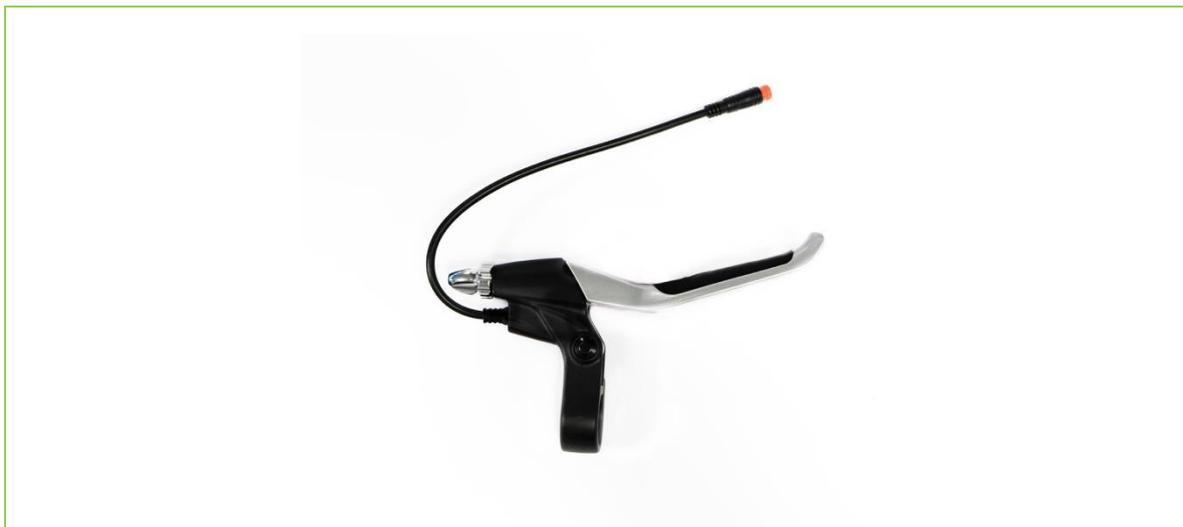
Lote 1 | Foto 8 | Par Manetes, com manípulo da manete com mínimo de 11cm, Controlo Travão, Cabo 250mm – em metal cromado para bicicleta elétrica, conforme foto abaixo (Direita)
