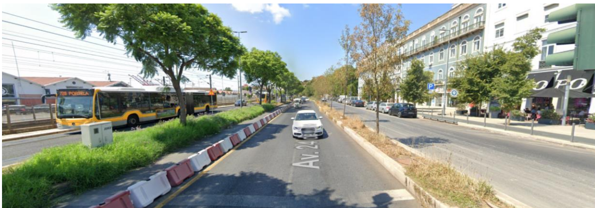
Vista de rua da Avenida 24 de Julho. Exemplo de corredores separados BUS/automóvel. Fonte: Google Maps
