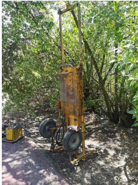
**Figura 2.5** – Aspeto do equipamento DPSH
