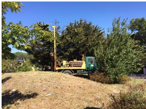
**Figura 2.2** – Equipamento *Mobile Drill B47 HD* montado em veículo de rastos
