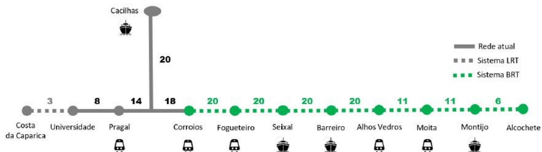
Figura 8 – Conceito 2: Número de circulações por hora e sentido necessárias por família (otimista).
