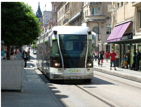
Figura 5 – Sistema sobre pneus com guiamento mecânico de um só carril – sistema TVR
