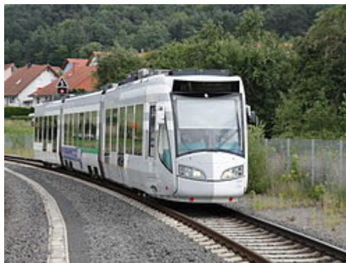
Figura 7 – Veículo tram-train diesel-elétrico (dual mode) – Kassel (Alemanha)
