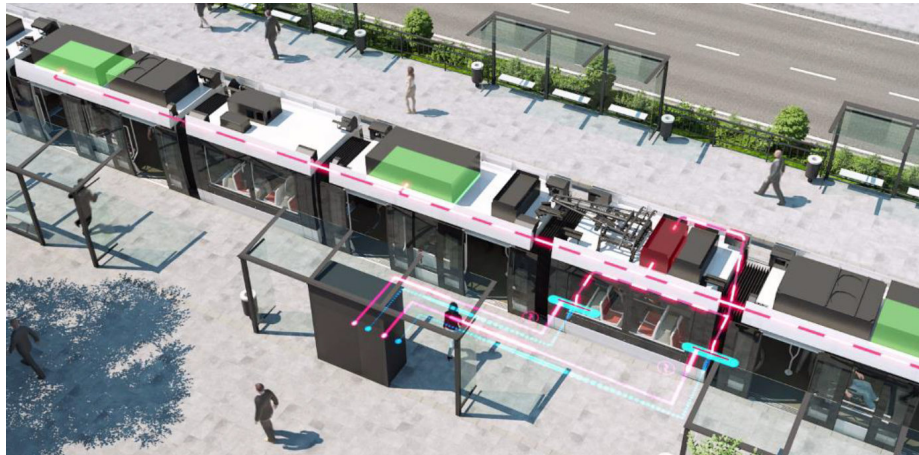
Figura 8 – Carregamento de oportunidade em paragem através de dispositivos embebidos (Ecopack)
