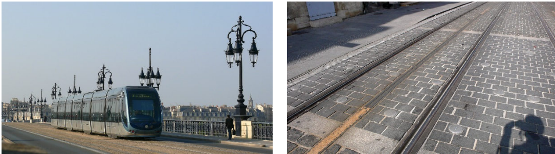
Figura 9 – Alimentação por terceiro carril embebido – Bordeaux (França)
