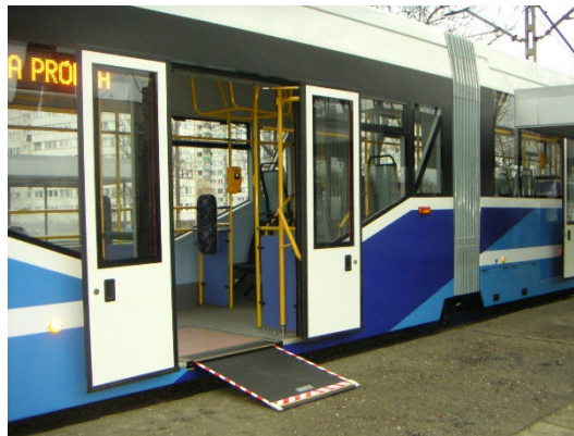
Figura 12 – Acesso ao veículo LRT através de rampas retráteis
