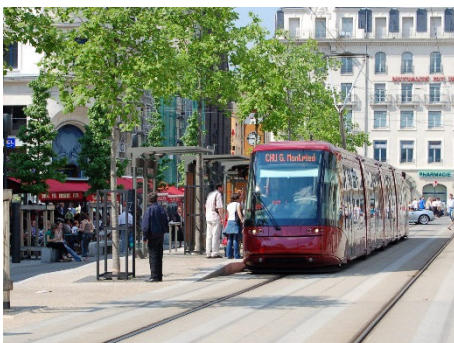
Figura 6 – Sistema sobre pneus com guiamento mecânico – sistema Translohr
