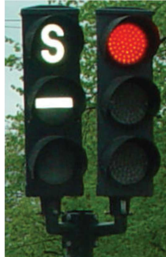
Figura 28 – Sinalização semafórica específica para autocarros e elétricos (COST TU0603, 2011)
