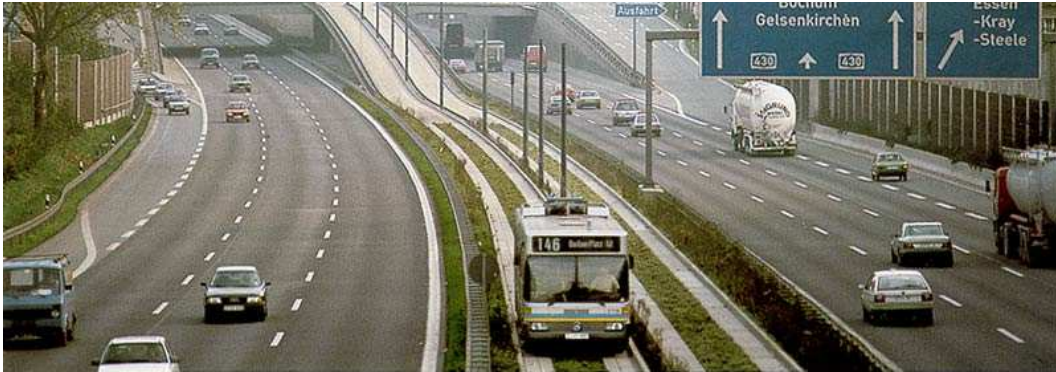
Figura 7 – Autocarro com guiamento mecânico ( http://citytransport.info )
