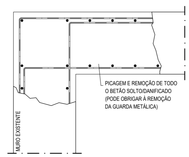
PORMENOR 2 - ALÇADO 2. PICAGEM E LIMPEZA ESCALA 1:20
