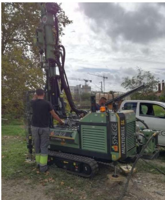
Figura VI – Sonda utilizada (Fraste multidrill SL).
