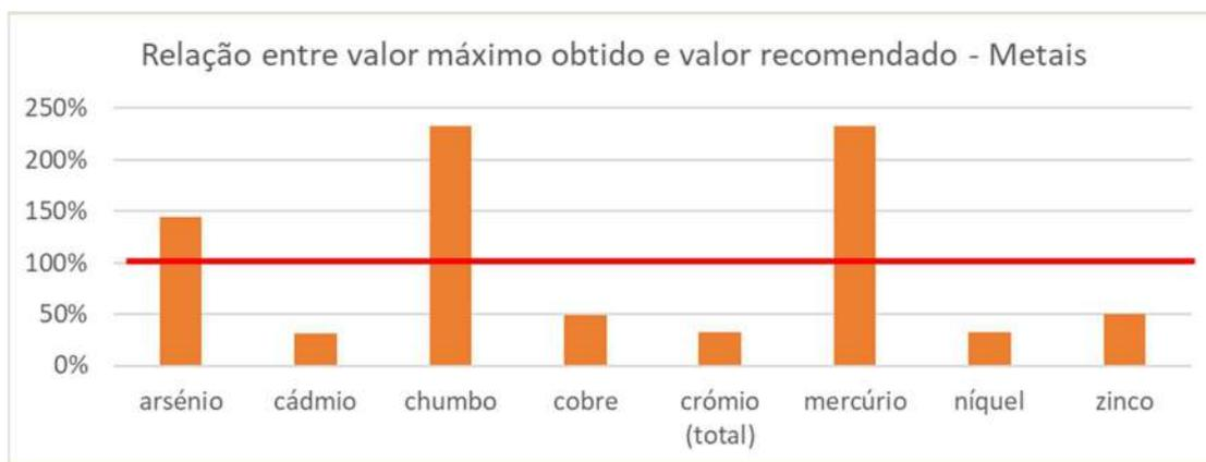
Figura X – Relação entre o valor máximo obtido para cada metal analisado nas amostras das sondagens e o valor de referência (linha a vermelho)
