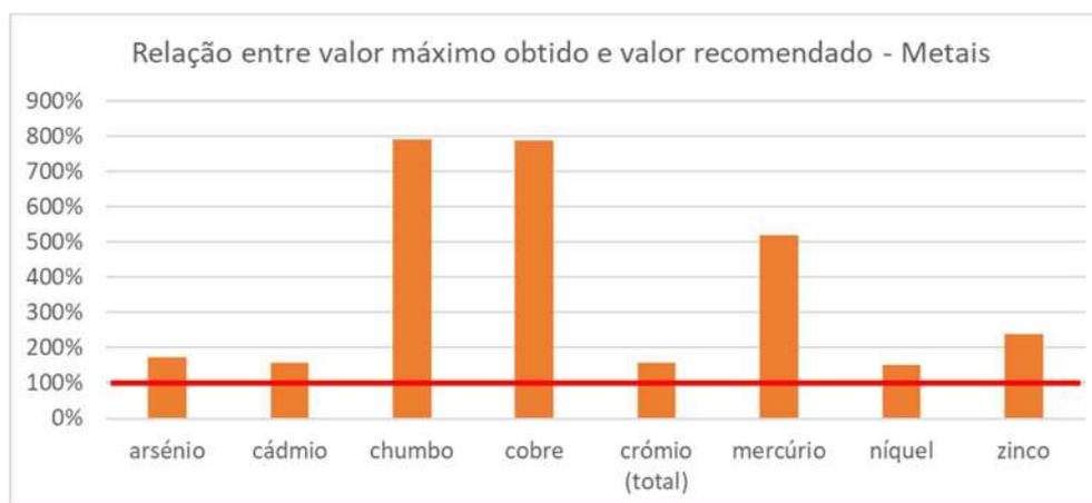
Figura IX – Relação entre o valor máximo obtido para cada metal analisado nas amostras dos poços e o valor de referência (linha a vermelho)
