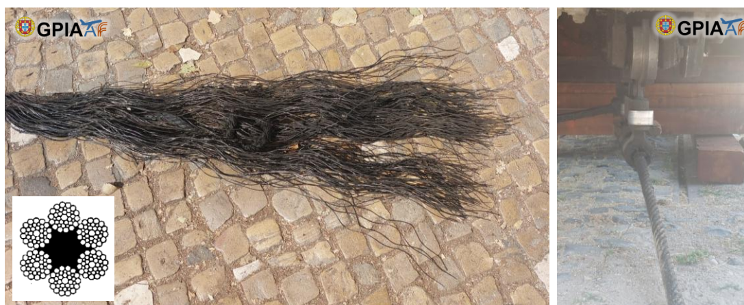
Fig. 5 - Situação final da extremidade do cabo que se libertou de dentro do trambolho superior da cabina n.º 1, com ilustração da secção nominal do cabo (imagem à esquerda) e situação normal do cabo inserido no trambolho superior (imagem à direita)
