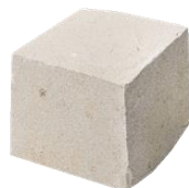
Figura 11 - Cubos de calcário vidroço com dimensões 5x5x5cm
